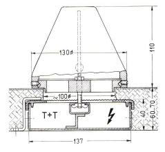
können nach dem Einbetonieren an jeder beliebigen Stelle angebohrt und mit Anschlussaufsätzen und Anschluss-Ständern versehen werden
