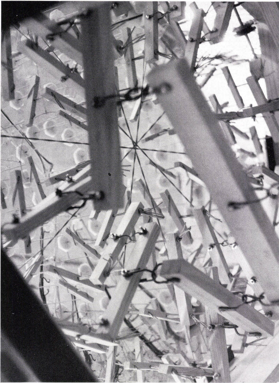
1 Belastungseinrichtung der Modellanlage. Dispositions pour essais en maquette de différents cas de charge. Load device on model.
