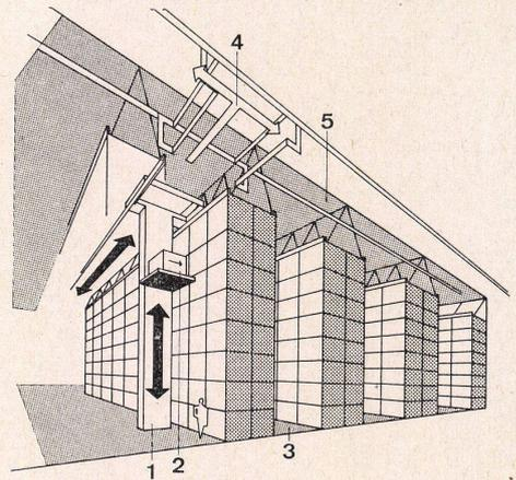
4 Regalstapelanlage. Fahrast oder -turm, üblicherweise auf den Regalen beidseitig der Regalstraße geführt. Im Gegensatz zur Stapelkrananlage kann in jeder Regalstraße ein Bedienungsgeschäft arbeiten. Es kann aber auch durch Querversetzvorrichtungen an den Kopfenden der Regalstraßen jedes Bedienungsgeschäft in jede beliebige Straße eingefahren werden.
