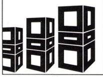
Serienfabrikation von Norm-Klimaapparaten: Pat. Baukastensystem, 10 Leistungsklassen, 500-75 000 m<sup>3</sup>/h
