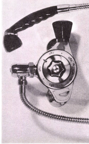
3971 BHJ beweglicher Duschenanschlussbogen mit Rückstromsiche-rung, Handdusche und Aufhängehaken Alle Mischventile für Wandmontage (für Dusche, Bidet, Waschtisch, Spültisch) mit freiem Auslauf. Abspernung des Kalt- und Warmwassers vor der Mischkammer durch eingebautes kombiniertes Absperrorgan.
