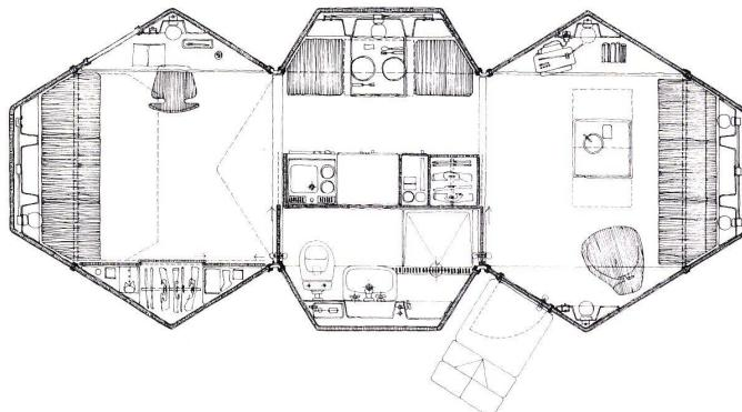
Das »Poly-Box«-Bausystem besteht aus zerlegbaren dodekaederförmigen Raumzellen mit einer Seitenlänge von 2,50 Metern. Die Verbindung der um rund 70 cm vertieften quadratischen Standardelemente (wahlweise aus Integral-Hartschaum oder glasfaserverstärktem Polyester) erfolgt durch Neopren-Dichtungsprofile, welche auf der Klemmwirkung des Profils beruhen. Durch Verwendung eines zusätzlichen Raumtragwerks ist es möglich, die Raumzellen auch aufeinander zu stapeln.
