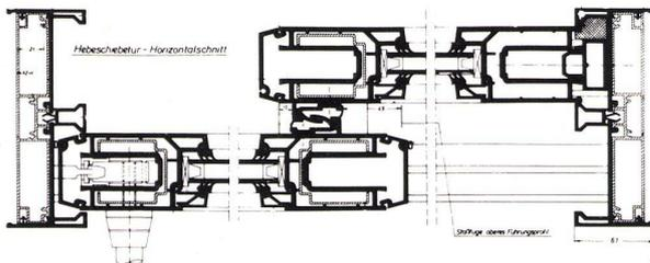
Eine umfangreiche Profillalette ermöglicht den Bau aller Fensterformen und Öffnungsarten einschl. Hebeschiebetür (siehe Querschnitt).
