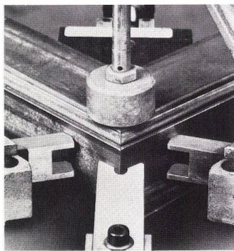
nende Eckwinkel aus Stahl. Dadurch ergibt sich eine Konstruktion von höchster Stabilität und Dauerhaftigkeit. Die Verbindung von Stahl auf Stahl verunmöglicht eine elektrochemische Korrosion, wie sie bei Verwendung von zwei verschiedenen Metallen auftritt. Der Zusammenbau erfolgt mit Hilfe der bewährten Eckverbindungsmaschinen. Diese arbeiten im Preßverfahren und gewährleisten geschlossene Gehrungen und eine Stabilität, die derjenigen der Schweißung entspricht.
