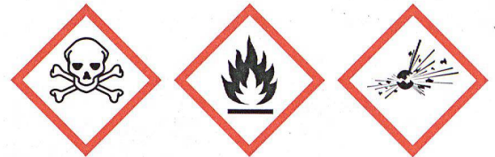
Neue, einheitliche Gefahrenpiktogramme für chemische Substanzen (von links): «Akute Toxizität», «Entzündbar», «Instabile explosive Stoffe».
