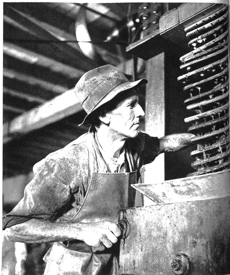
In Presstücher verpackt wird das Mahlgut in vielen Lagen unter die hydraulische Presse gebracht. Goldig rinnt der Saft hinunter.
