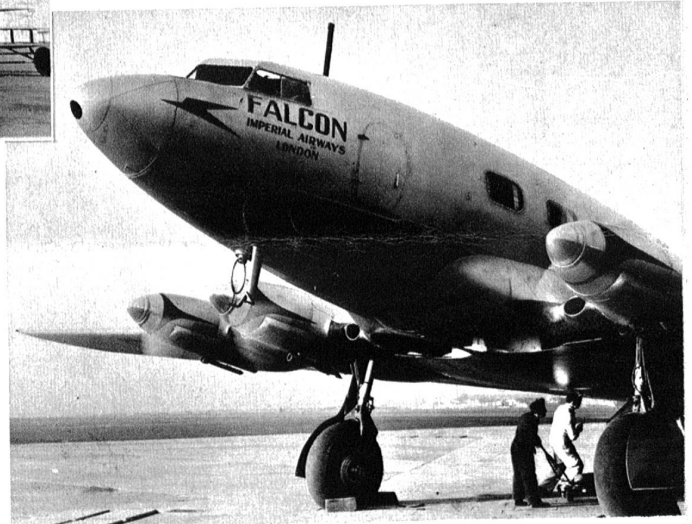
Das Viermotorenflugzeug „Falcon“ der Imperial Airways, das im Flugdienst Zürich-London eingesetzt wird. Flugdauer Dübendorf-Croydon: 153 Minuten. 22 Passagiere, vierköpfige Besatzung, Fracht und Post. Flügelspannweite 32 Meter, Gesamtlänge 22 Meter, Höhe 6,8 Meter Höhe des Salons 1,9 Meter, komplett ausgerüstete Küche, Einzichbares Fahrgestell. 320 Stundenkilometer Verkehrsgeschwindigkeit.
