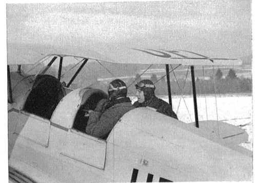
Am Doppelsteuer-Schulflugzeug. Der Schüler wird mit den Bordinstrumenten vertraut gemacht.
