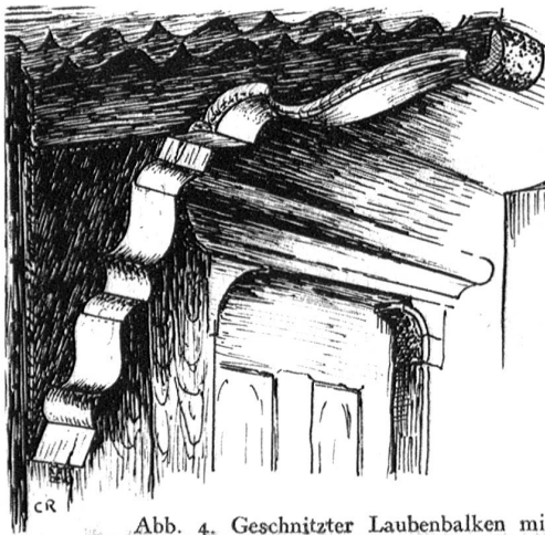
Abb. 4. Geschnitzter Laubenbalken mit stützender Konsole am Hause des E. Rothenbühler in Rüderswil, 1775.
