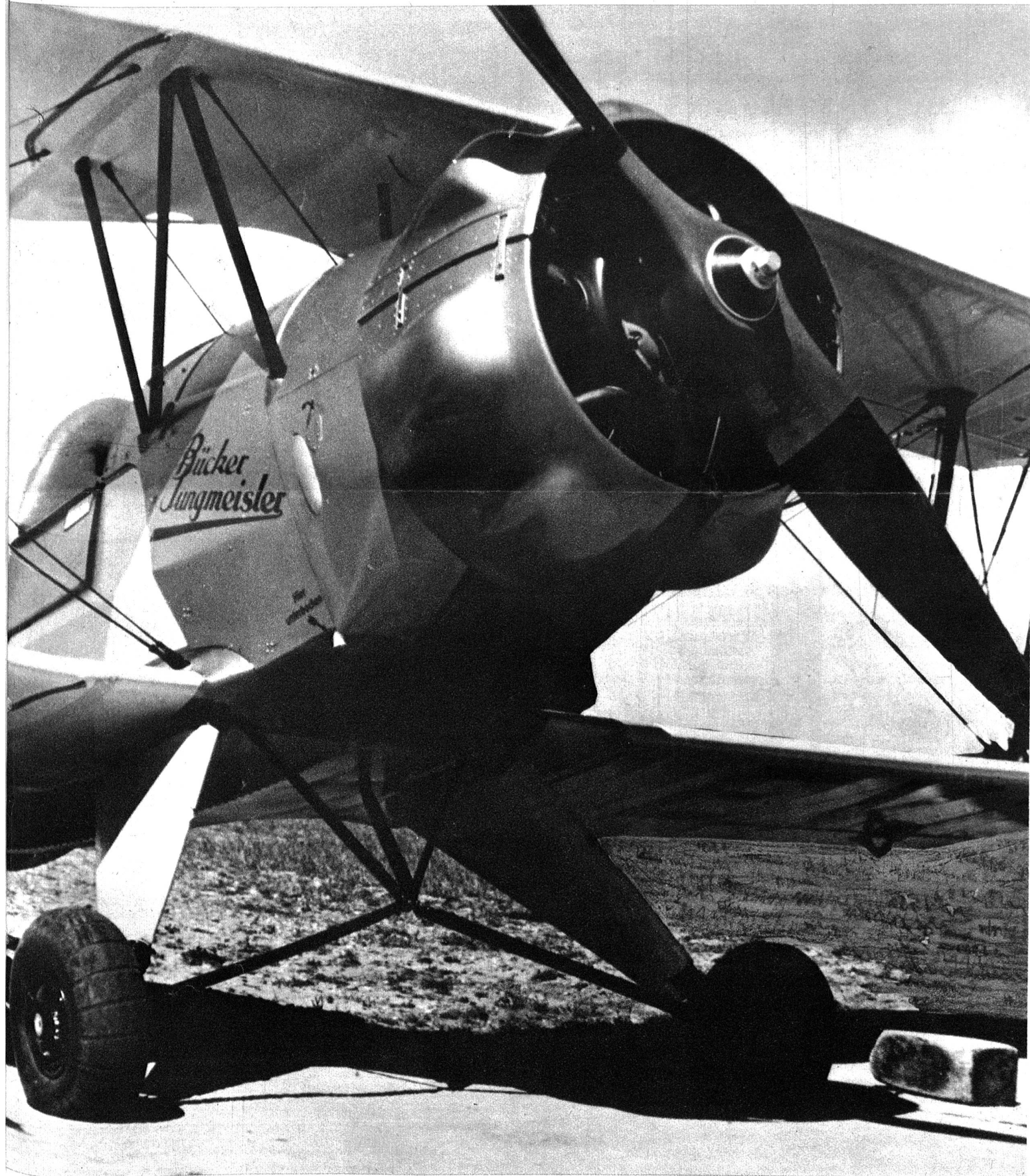
Das moderne, akrobatiktaugliche Sportflugzeug Bucker-Jungmeister; Spannweite 6,60 m, Länge 6,15 m.
