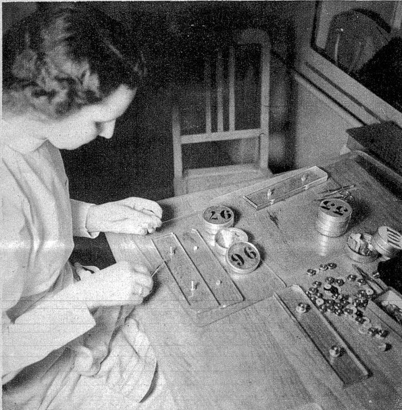
Von jeder Probe werden mit einer krummen Schere möglichst kleine Stückchen in der Längsrichtung der Muskelfaser abgeschnitten und auf eine Glasplatte ausgebreitet. Durch Auflegen und Festschrauben einer zweiten Glasplatte werden die Stückchen durchsichtig düngepresst. Diese ganze Arbeit erfordert eine geschickte, ruhige Hand.
