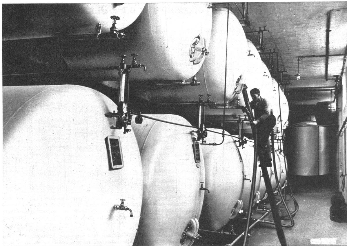
Süssmosttanks für die Lagerung von Süssmost und Süssmostkonzentrat von je 500 hl Inhalt. Seit Inkrafttreten der Alkoholgesetzgebung hat die Herstellung von Süssmost einen gewaltigen Aufschwung genommen. Die Schweiz steht in der Herstellungstechnik in der Qualität an 1. Stelle
