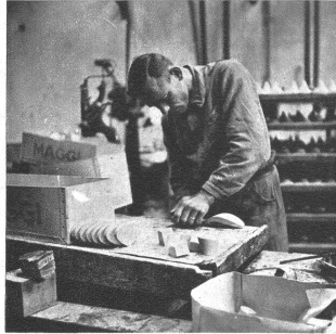
Bei diesem Modell sind Sohle und Absatz nicht aus einem Stück, sondern zusammengeleimt.
