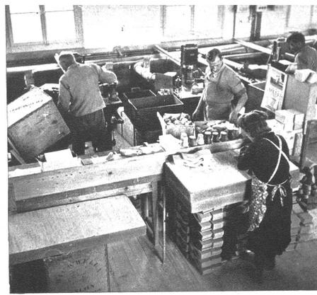
Mittels Schablonen werden auch die Korkplatten möglichst rationell ausgenützt.
