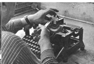
Haarscharf müssen die Typenhebel in die Zentralführung passen. Diese macht 22 Arbeitsvorgänge und 9 Überprüfungen durch und ist hier genau zu sehen
