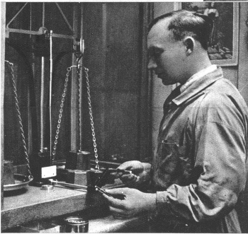
Auf der Prüfwaage. Mit der Pinzette werden bis zum exakten Gewicht Schrotkörner zugegeben, dieselben sodann der Kernmasse beigestampft, worauf die Stempelung erfolgt.
