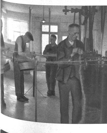
Oben: Fertige Strängen des gesponnenen Pferde- haars kommen in die Lagerhalle. Unten: Das rohe Pferdehaar wird zu Schnüren gedreht
