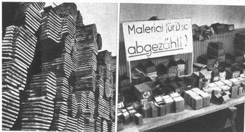
Ein sorgsam angelegtes Holzlager sichert die kontinuierliche Arbeit in der Schreinerei. — Oben rechts: Material für D 10 — hess die Zusammenstellung des Materials zur Serienmontage der Dreschmaschinen Aebi No. 10
