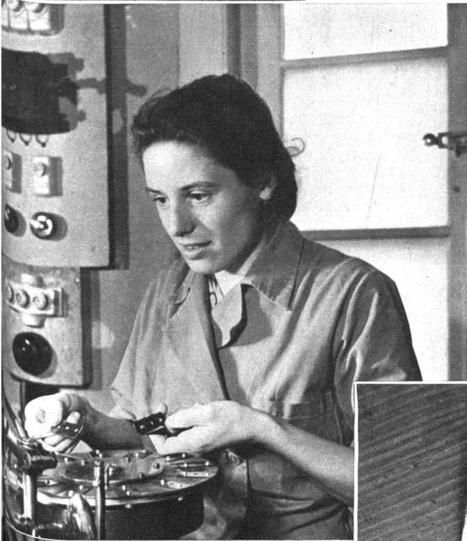
Oben links: Der Halbautomat mit den zur Verpackung gelangenden Klingen. Das Auflegen der Klingen in den Apparat wird von der Arbeiterin direkt vorgenommen
