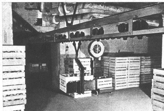
Links: Einlagerung. Zufuhr durch Transportkette
