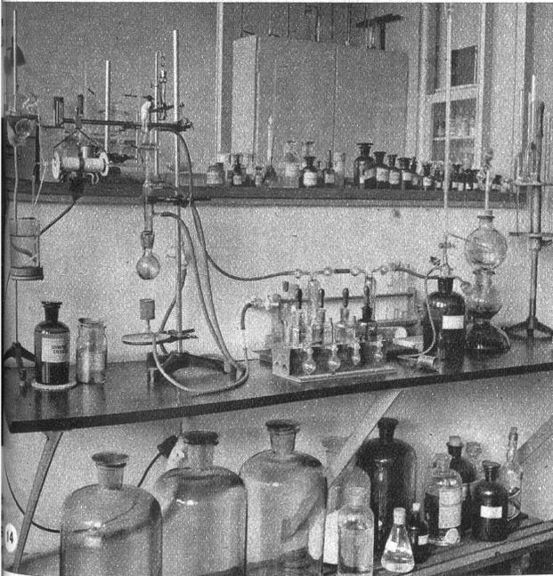
Abbildung 15 Arsenbestimmungsapparat nach Gangl: Die Arsenbestimmung nach Gangl ist eine mikro-chemische Methode, mit welcher das Arsen bis auf tausendstel Milligramm genau bestimmt werden kann.
