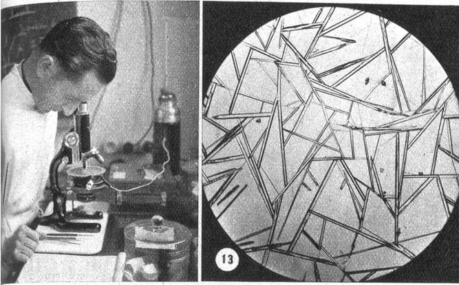
Der chemische Assistent am Mikroschmelzpunktapparat nach Koffler. Dieser Apparat wird bei den toxikologischen Arbeiten häufig gebraucht. Er dient in erster Linie zur Bestimmung von Schmelzpunkten, sowie zur Reinigung der erhaltenen Produkte, wie sie beim toxikologischen Arbeiten anfallen.
