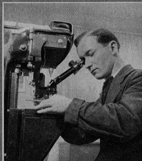
Vickers Härteprüfer für Stahl. Durch diesen Apparat misst man, wie der Name schon selber sagt, den Härtegrad des Untersuchungsobjektes
