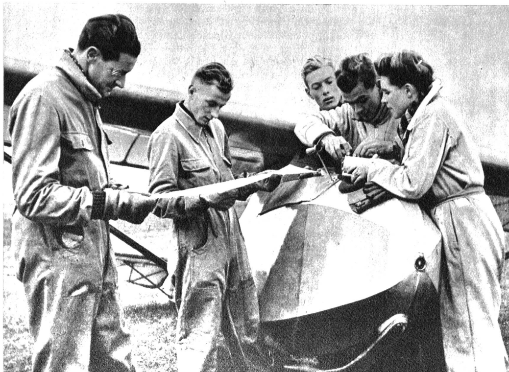
Links: Der Barograph wird kontrolliert. Mit diesem Apparat werden automatisch die Höhenkurven aufgezeichnet und der Flug kann nachträglich theoretisch nochmals verfolgt werden
