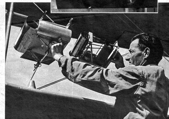
Unteressen wird der Meteorograph, welcher die Flughöhe, die Lufttemperatur und die Feuchtigkeit registriert, in Gang gesetzt
