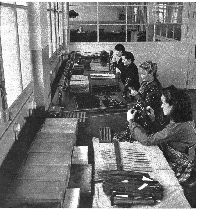
Elektrischer Warmluftofen zum Anlassen von Uhrenfedernbändern bei einer Temperatur von zirka 500°C. Links: Die Kontrolle auf Härte und Elastizität im Labor. Rechts: Ansicht des Arbeitsraumes, in welchem die Uhrenfedernbänder zu Spiralen gewickelt werden.
