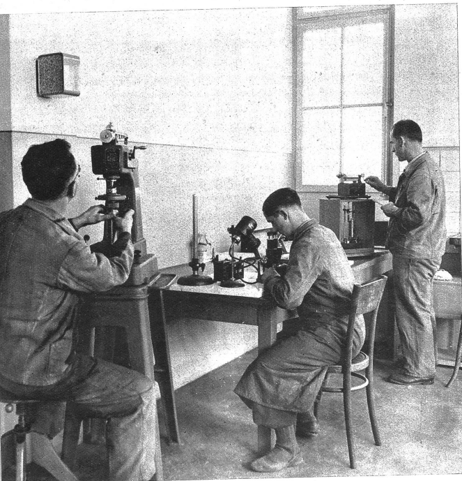
Elektrischer Warmluftofen zum Anlassen von Uhrenfedernbändern bei einer Temperatur von zirka 500°C. Links: Die Kontrolle auf Härte und Elastizität im Labor. Rechts: Ansicht des Arbeitsraumes, in welchem die Uhrenfedernbänder zu Spiralen gewickelt werden.
