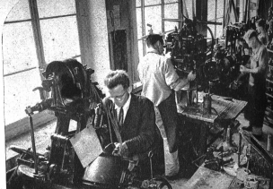
Die Lederschuh-Zwickerei. Hier wird dem Schuh gewisse der Charakter gegeben, denn mit Hilfe dieser Menschen-Wunder der Technik sind, wird der Schaft über die festsogenannten Leisten an die Brandsohle befestigt
