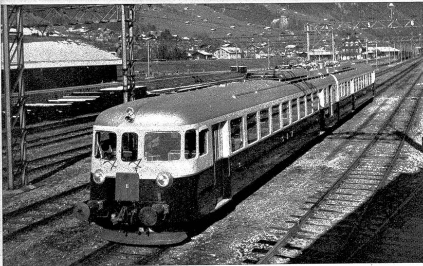
Demnächst soll auf der Strecke Spiez-Zweisimmen, später auf den Linien des Gürbetals und Bern-Neuenburg ein neuer Leichttriebwagen eingesetzt werden, der folgende technische Daten aufweist: Leichttriebwagen Typ BCFe 4/8, 1000 PS, 110 km/h Höchstgeschwindigkeit, 174 Sitzplätze, 47 m lang. Die Komposition bildet eine Weiterentwicklung dreier, seit 1938 in Betrieb stehender, bewährter Triebzüge ähnlicher Bauart. (Photopress)
