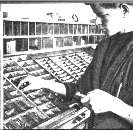
Der Setzerlehrling am Setzkasten, in der linken Hand den Winkelhaken, in welchen Buchstabe um Buchstabe gesetzt wird
