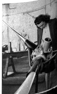
Rechts: Ein Propeller mit verstellbaren Metallflügeln ist ein kleines technisches Wunderwerk, das die Bewunderung einer jungen, sachverständigen Dame erregt
