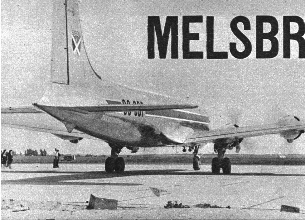
Spannweite 35,81 m, Länge 28,63 m, Höhe 8,41 m, Tragfläche 134,77 m<sup>2</sup>, 6800 PS, Aktionsradius 6920 km, normale Fluggeschwindigkeit auf der Strecke 335 km/h, Vollgewicht beim Start 33 Tonnen.
