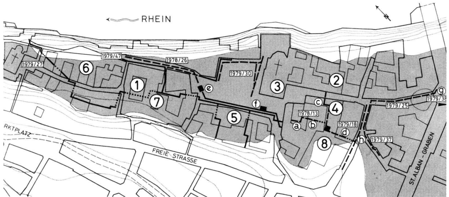
Abb. 8. Münsterhügel, Leitungsbauten 1978/1979. Leitungsgräben Etappe 1978 (—) Etappe 1979 (----). Zeichnung: H. Schaub. – Massstab 1:5000.
