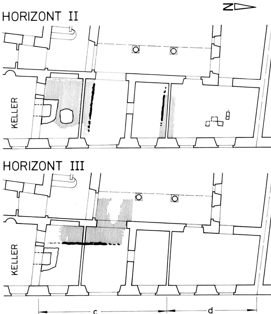
Abb. 32. Nadelberg 20, 1985/31, alter Rosshof. Planskizze der Holzbauten der Siedlungshorizonte II und III in den Holzbauzonen Abb. 30,c,d. Schwarze Linien: Steinlagen als Unterlage zu Schwellbalken, Raster: Lehmestrich der Holzbauten. Vierecksignatur: Gruben. – Zeichnung: Ch. Bing. – Massstab 1:200.
