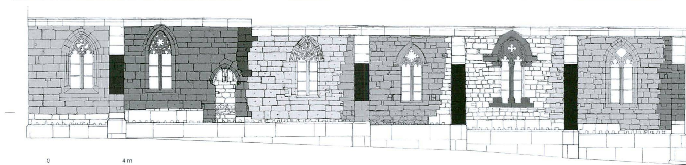
Fig. 15 Romont/Collégiale. Relevé du bas-côté sud avec indication des différentes phases de construction
