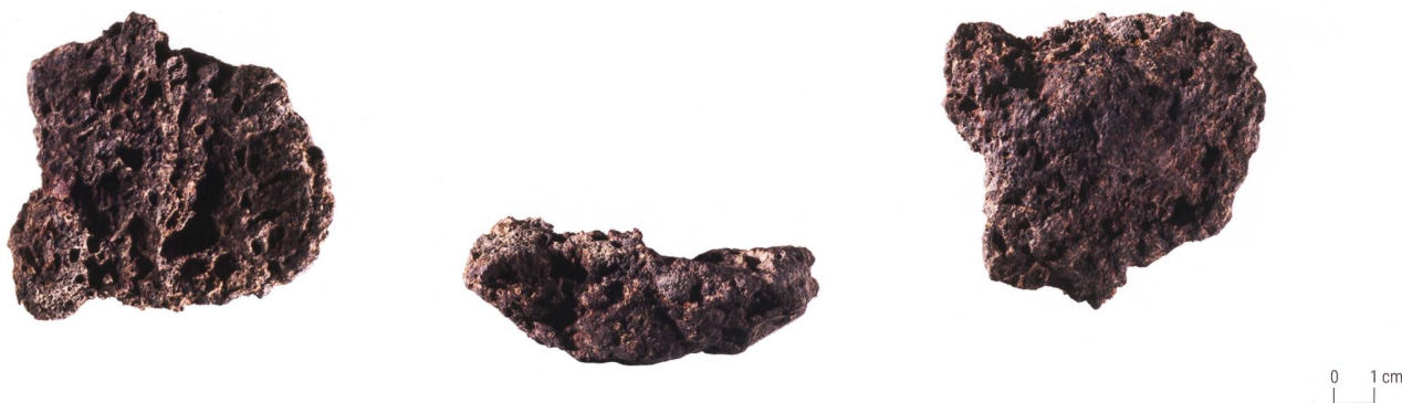
Fig. 28 Saint-Aubin/Sous la Rochetta, scorie en calotte de forme plano-convexe (SAU-RO 2015-141/18)
