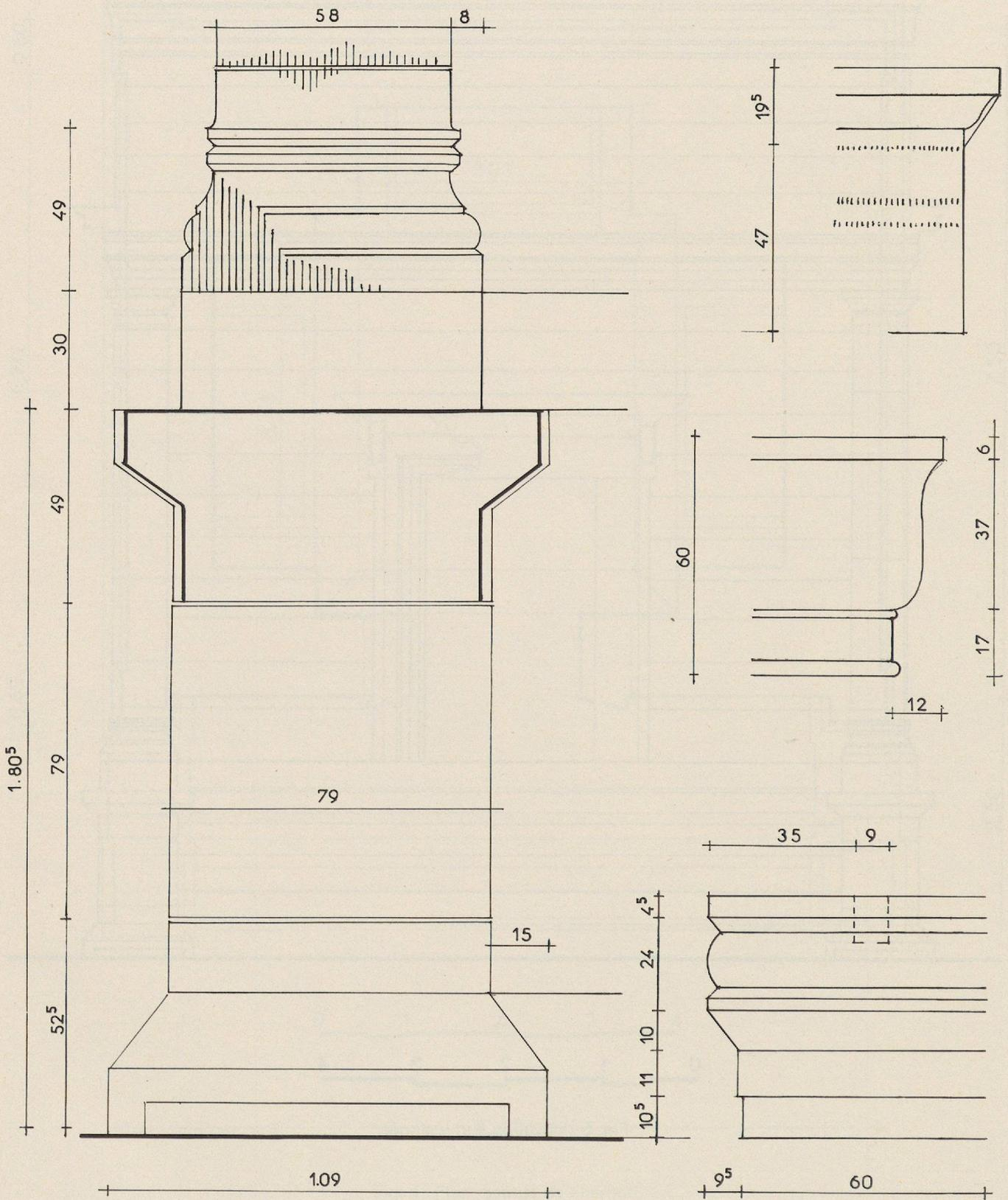
Fig. 6: A gauche: restitution du podium et des bases de pilastres (chambre et avant-corps); à droite, en haut: chapiteau de pilastre; au milieu: doucine de couronnement (sima); en bas: architrave et frise d'entablement.
