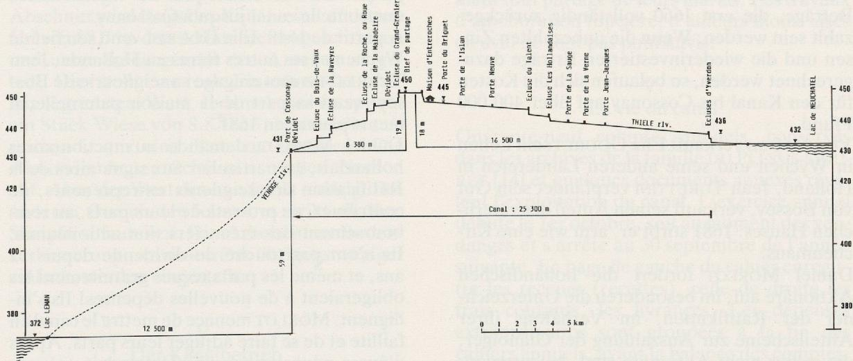
Abb. 10 Theoretisches Profil des Kanales von Entreroches.
