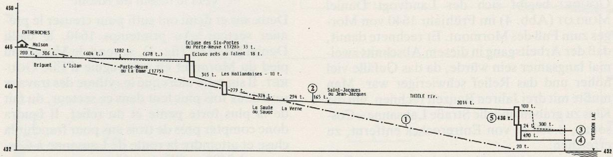
Abb. 8a Profil des Kanals von Entreroches, nach alten Vermessungsangaben gezeichnet.
