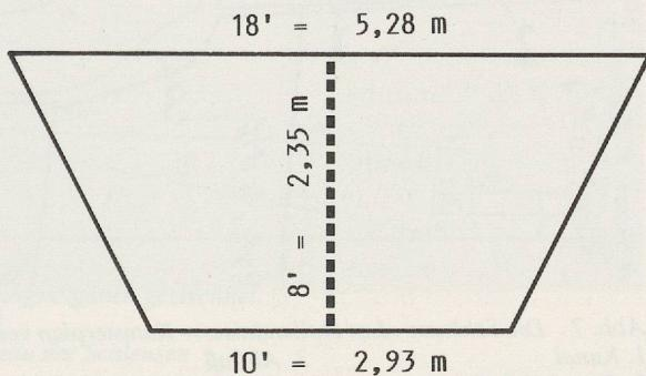
Abb. 6 Theoretisches Profil (Schnitzzeichnung) des Kanals.
