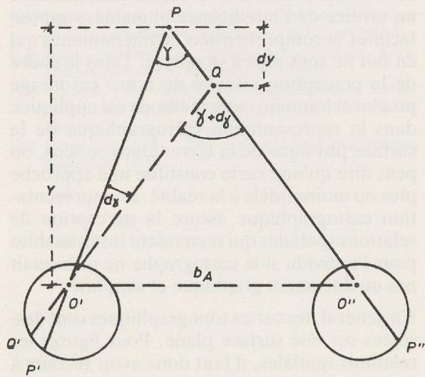
Abb. 1: Beim Blick zum Punkt  $P$  bilden die Augachsen den Konvergenzwinkel  $\gamma$ . Dieser wird bei näher gelegenen Punkten (z.B.  $Q$ ) größer, bei entfernt liegenden Punkten wird er kleiner (vergl. [6]).
