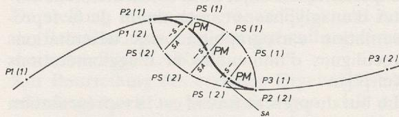
Abb. 4:  $P_1, 2, 3 (1)$  Stützpunkte des ersten Parabolbogens
