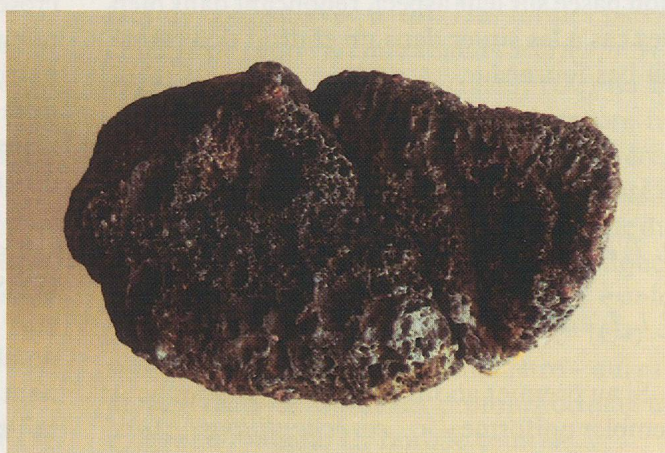
Fig. 31 Scorie ayant coulé sur une surface plane et provenant du bas-fourneau IIb - échantillon n° 7 (Photos LAHA).
