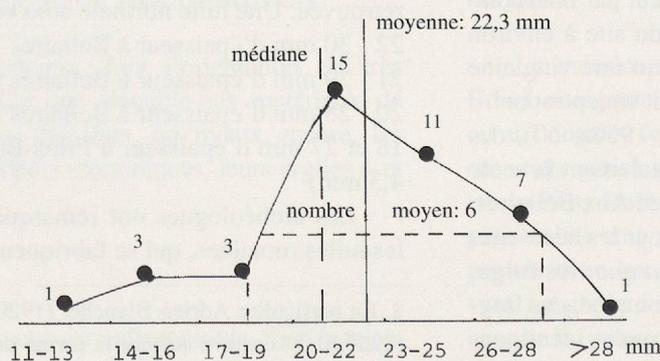
Fig. 134. Épaisseur des tuiles plates.
