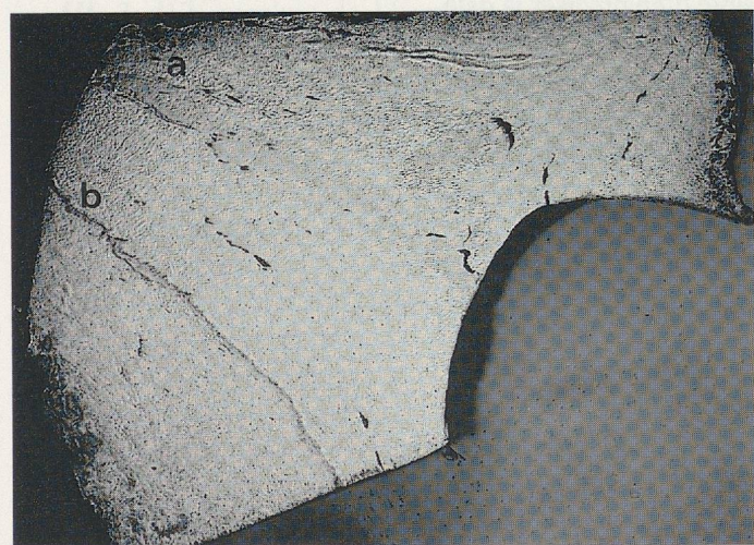
Fig. 165. Agrandissement 7:1 (Photo Gebrüder Sulzer AG, 22105 G) a) voir agrandissement 50:1. b) marque de soudure au rouge. Le forgeron a fabriqué sa lame en repliant le métal.
