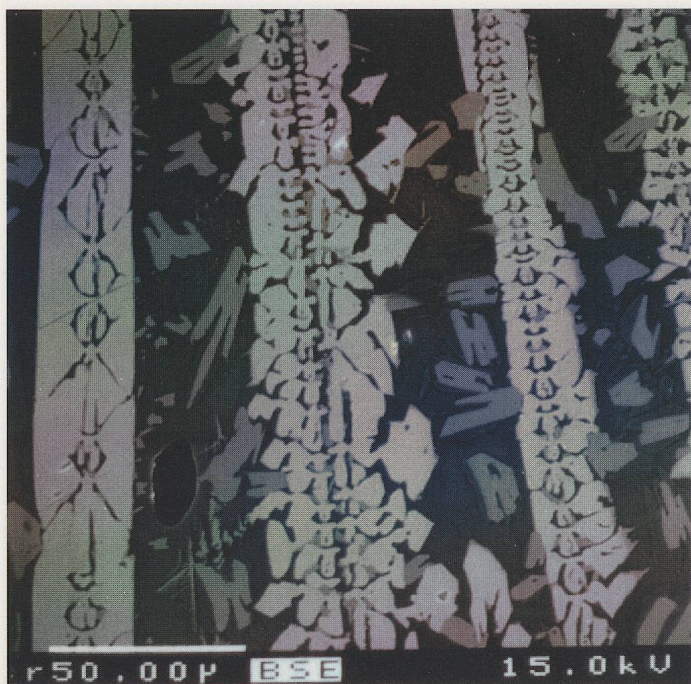
Fig. 23. Les cristaux du minéral de la famille de la rhönite apparaissent en gris moyen. Ech. MON 52. Image en électrons retrodiffusés.
