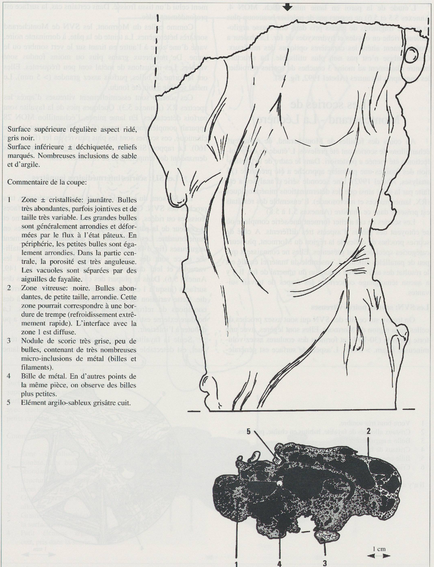
Fig. 148. SIJ: scorie intermédiaire jaune, en forme de tuyau. Ech. MON 81 (Montcherand): vue de dessus et coupe.
