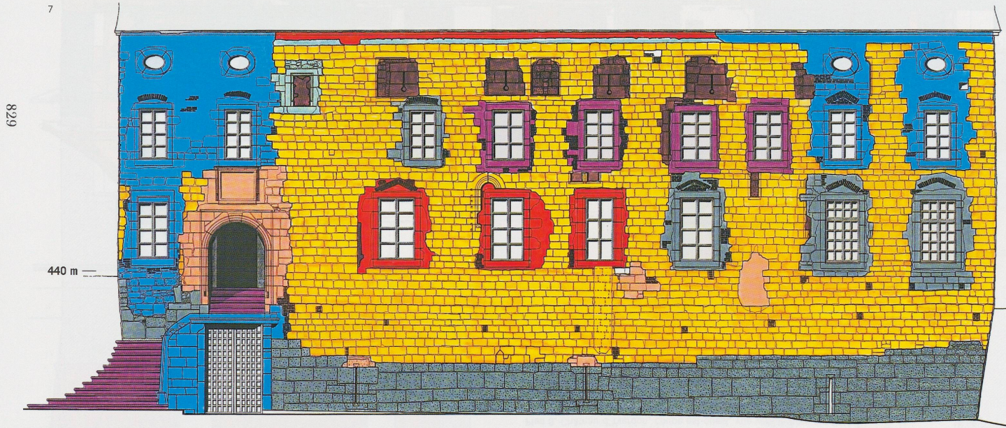
Plan 7. Château d'Yverdon, courtine nord, analyse archéologique de son élévation, sur la base du relevé d'Otto Schmid. (Relevés: AAM et Archéotech SA; mise au net: Franz Wadsack)
