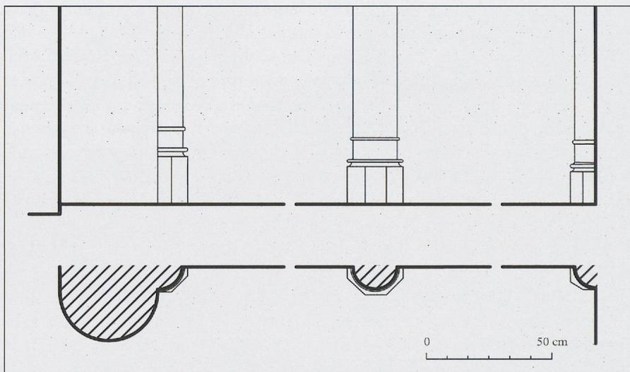
Fig. 358. L'église de Chapelle-sur-Moudon: élévation et plan des bases du chœur du côté nord (relevé de A.-L. Python Lecoultré, 2006).
