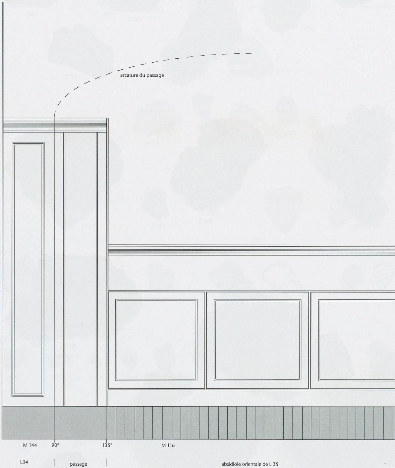
**Planche 146** L 34 - L35, développé du décor 35-1 au passage entre salle et abside, sur plinthe lithique (éch.: 1:25).
