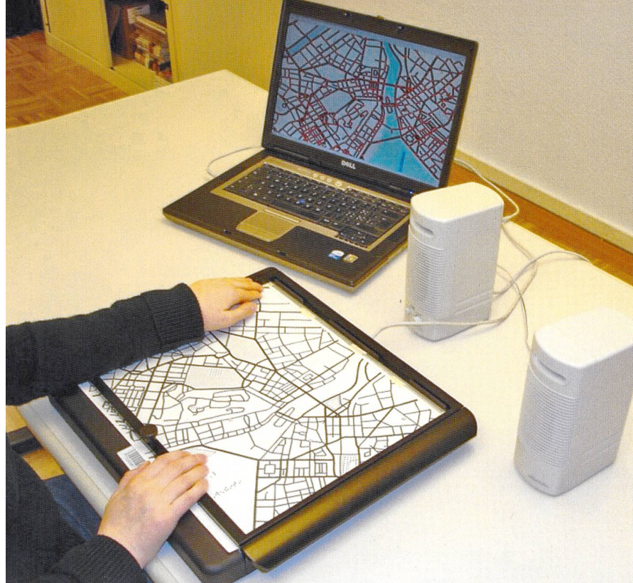
Abb. 1 oben: Bestandteile der Vorrichtung ABAPlans: ein Rechner, ein Tastfeld, ein Reliefplan und Lautsprecher
