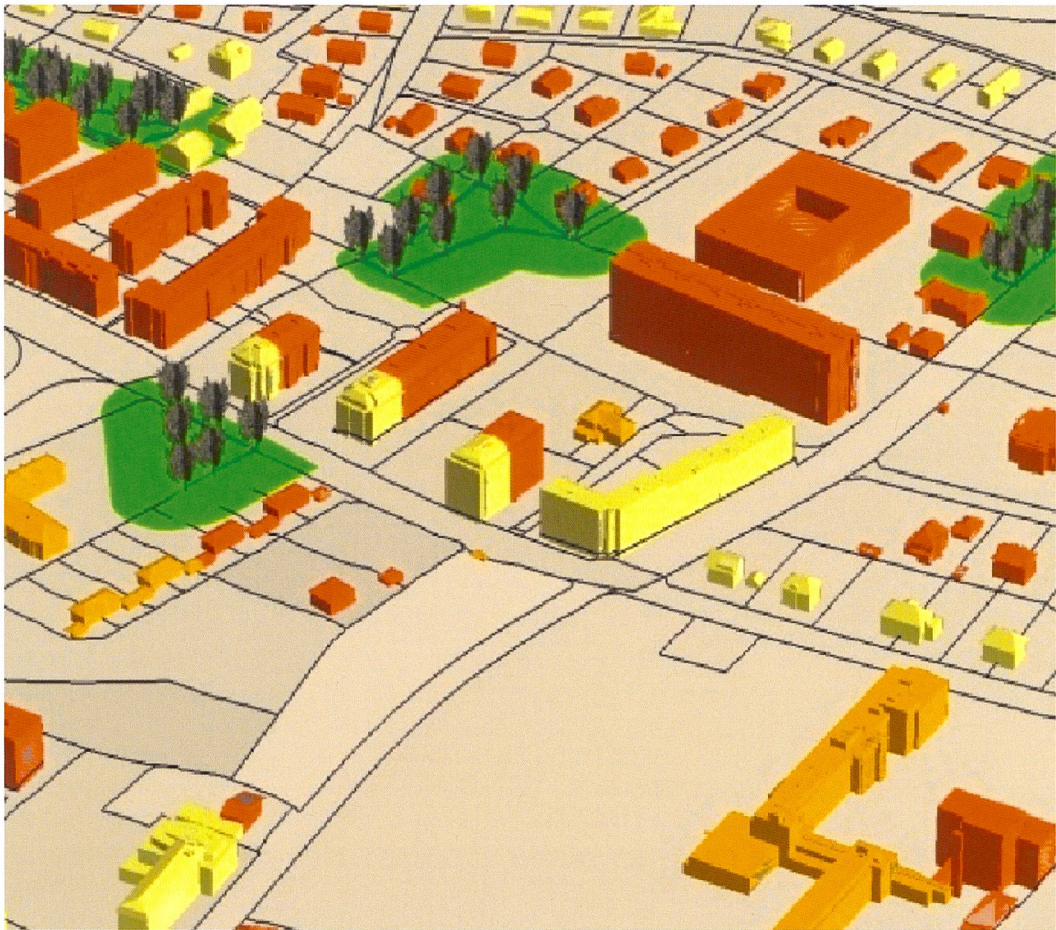
Abb. 3 unten rechts: Verfügbarer bebaubarer Raum über einer Parzelle im Ergebnis verschiedener Analysen (Raum- und Attributanalysen)
