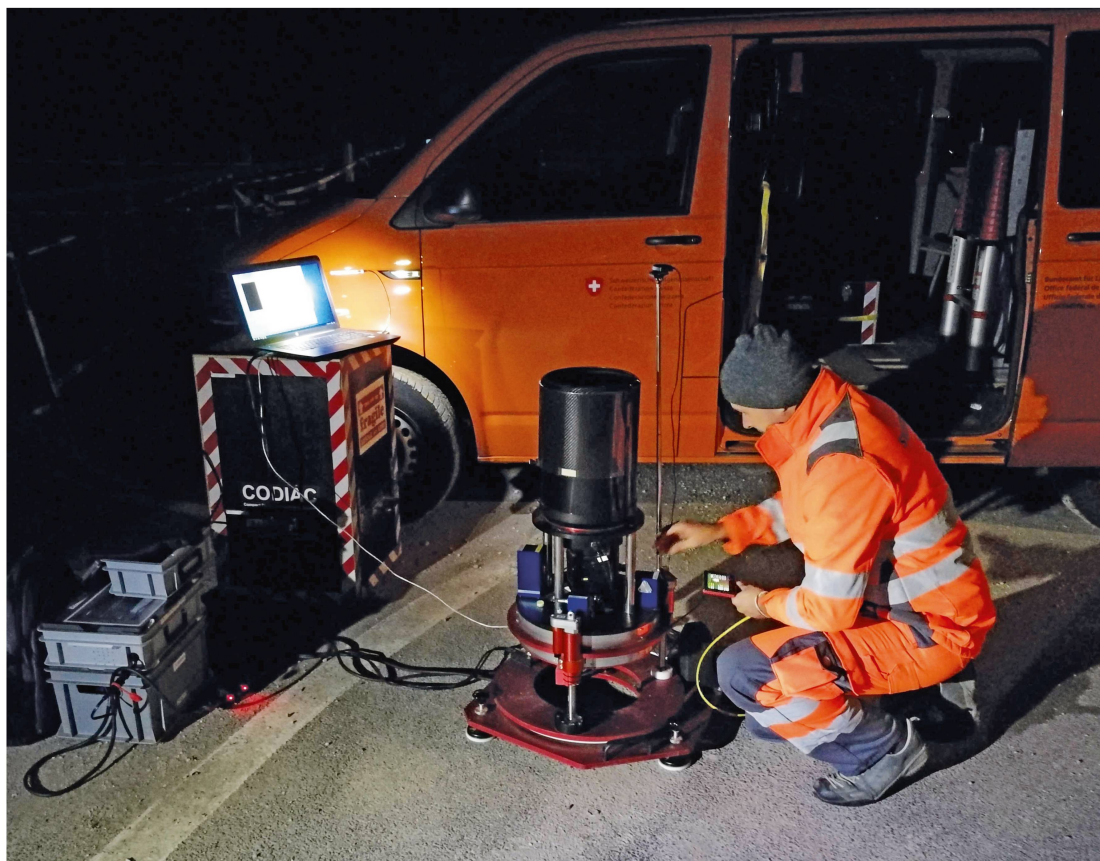
Abb.: Lotabweichungsmessung mit der digitalen Zenitkamera CODIAC
